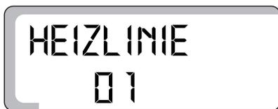
Taste „Anzeige“ gedrückt halten und Drehknopf drehen. In der ersten Anzeige wird die Heizwassertemperatur bei +10 °C, in der zweiten Anzeige bei ±0 °C und in der dritten Anzeige bei -10 °C angezeigt.
