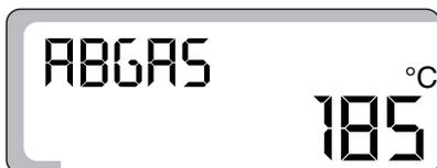
Im Display wird die Abgastemperschwelle angezeigt, ab der eine Fehlermeldung erfolgen soll.
