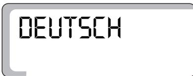
Serviceebene wie auf Seite 13 beschrieben aufrufen. Es erscheint „DEUTSCH“ als erstes Hauptmenü im Display. Durch Betätigen der Taste „Anzeige“ und Drehen des Drehknopfes lässt sich nun die Sprache einstellen. Die eingestellte Landessprache wird durch Loslassen der Taste „Anzeige“ gespeichert.
